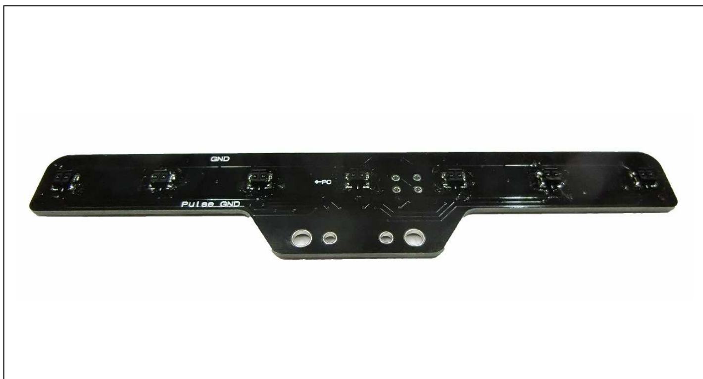
図 7 アナログセンサの半田付け後の写真
