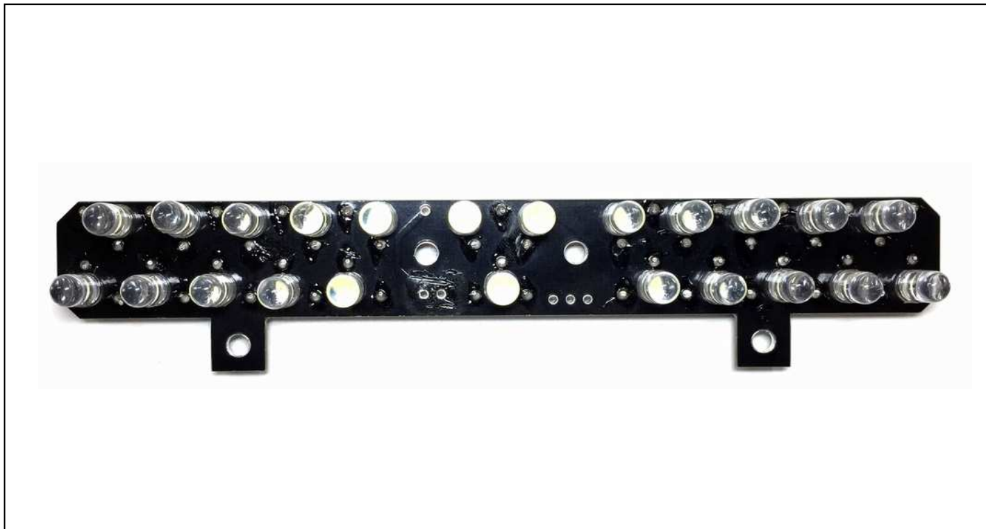
図 6 LED 半田付け後の写真
