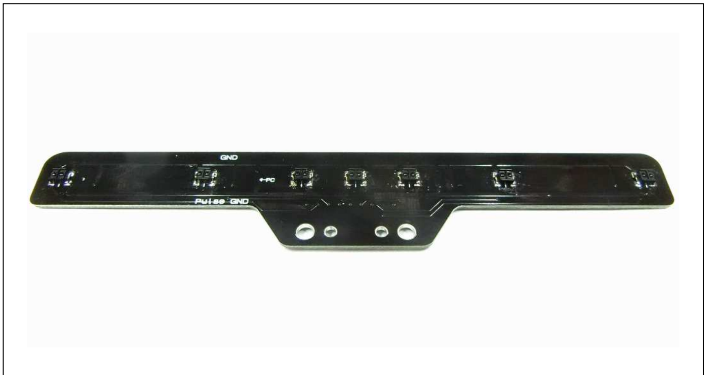
図 7 アナログセンサの半田付け後の写真
